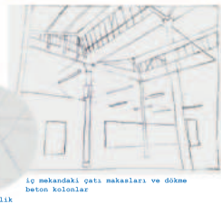
İç mekandaki çatı makasları ve dikme beton kolonlar
